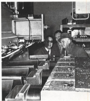
Casse interne di A.P. di un gruppo T/A da 32.500 kW in lavorazione per la Società Sordoli di Milano.
