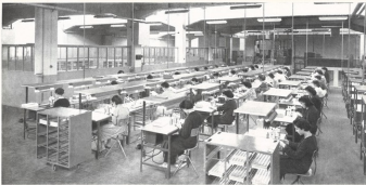
SALDINE di montaggio dello stabilimento Marconi dell'Aquila. Le operale siedono a banchi di fabbricazione americana razionalmente studiati per consentire le migliori condizioni di lavoro. I banchi sono dotati di addaltri elettrici e punti regolati elettronicamente, di razzeri ad aria compressa, di canneri a gas e di ogni altro dispositivo moderno necessario alla lavorazione di serie delle tubole.
