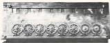
LA PASCALINE, macchina aritmetica chiusa. Pascal la progettò per aiutare il padre, controller fiscale della provincia di Rouen.
