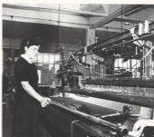
FATIGIANO (Bielva) telai delle Officine Mecaniche Pistolesi in azione presso la Stabilimento Tessile Fandella. Si tratta di 62 grandi macchine da lana collegate in sequenziale automatico.
