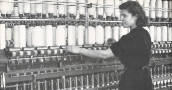
LEGNANO (Milano): filati continui ad anelli per alto giro forniti dalla Società San Giorgio di Genova alla Filatura San Giorgio di Legnano.
