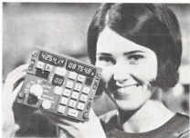
VOLI PIÙ SICURI CON I NAVIGATORI ELETTRICI ASSISTITIZZATI. - Pesa 25 kg. ed ha, come mostra la foto, la dimensione di un cubo di 30 cm. di lato questo nuovo tipo di apparato di navigazione inerziale miniaturizzato, capace di svolgere un'intera lastrica di un aereo. Il nuovo strumento di navigazione aerea (che comprende tra le altre apparecchiature, un giroscopio ed un computer elettronico), può fornire al pilota di un aereo ogni dato sulla navigazione di cui abbia bisogno: la posizione, l'orientamento, la velocità rispetto al suolo, l'assetto, la velocità e la direzione del vento, la rotta da seguire e persino la distanza e il tempo necessari per coprirla fino a destinazione, o tutto ciò senza l'aiuto di stazioni o riferimento a terra. La nuova strumentazione verrà installata sui DC-8-62 dell'Alitalia e sui Boeing 747 della nostra compagnia di bandiera che sostituiranno la semplice l'una postale.
