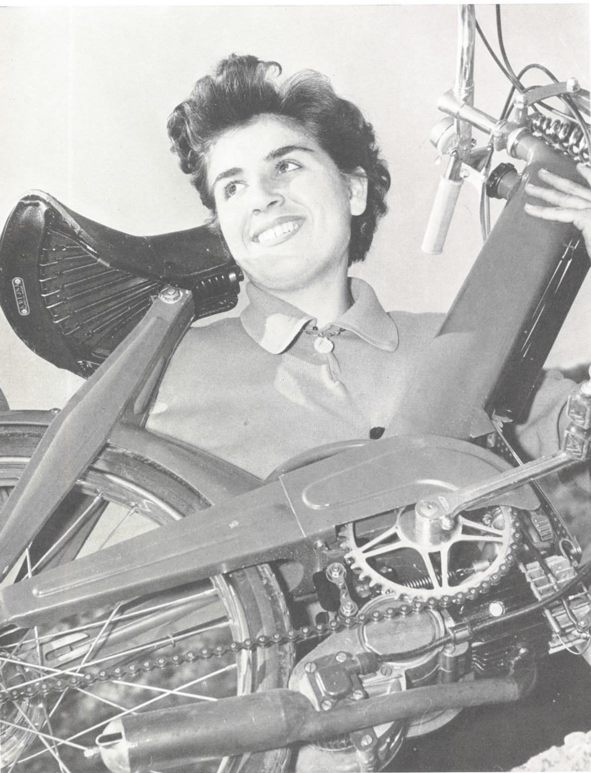
**CARATTERISTICHE** del Paperino sono la grande economia di benzina del suo motore Mosquito (un litro ogni 70 km) e la solidità del telaio stampato in lamiera. Il telaio del nuovo ciclomotore oltre ad avere una funzione resistente, ne ha una sua particolare: la trave centrale fa da serbatoio, il forcellone posteriore serve come copri catena, il puntone reggisella da scatola portattrezzi.
