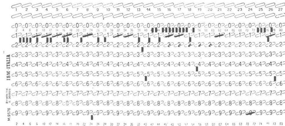
**RISULTATO** di ogni esplosione nucleare sui contatori colpiti riportato in una scheda mediante tratti a matita. I tratti della scheda vengono tradotti in perforazioni. Nelle colonne è indicato con 0 o 1 rispettivamente se esistono o meno angoli di 1, 2, 3 unità.
