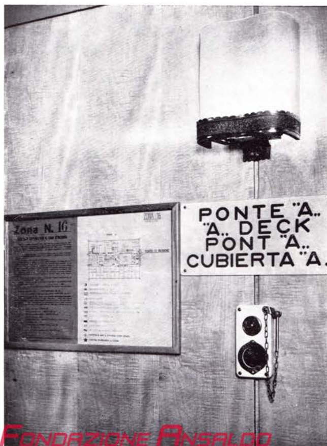
Ponte « A » - Particolare di una delle « Zone d'incendio » distribuite sulla nave
