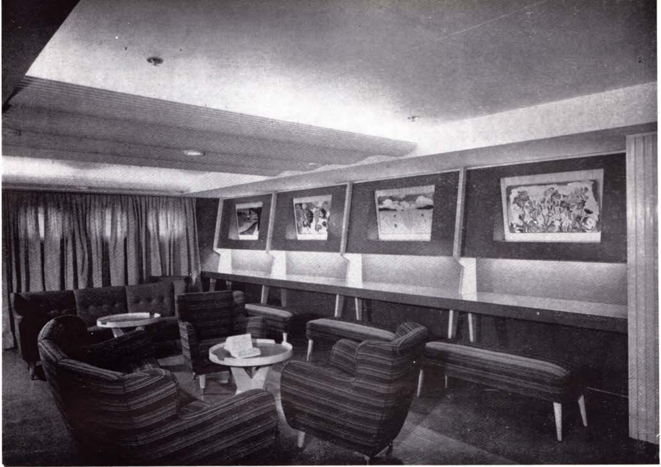
Sala scrittura Classe Turistica - A soffitto sono visibili le teste d'estinzione dell'impianto Sprinkler.
