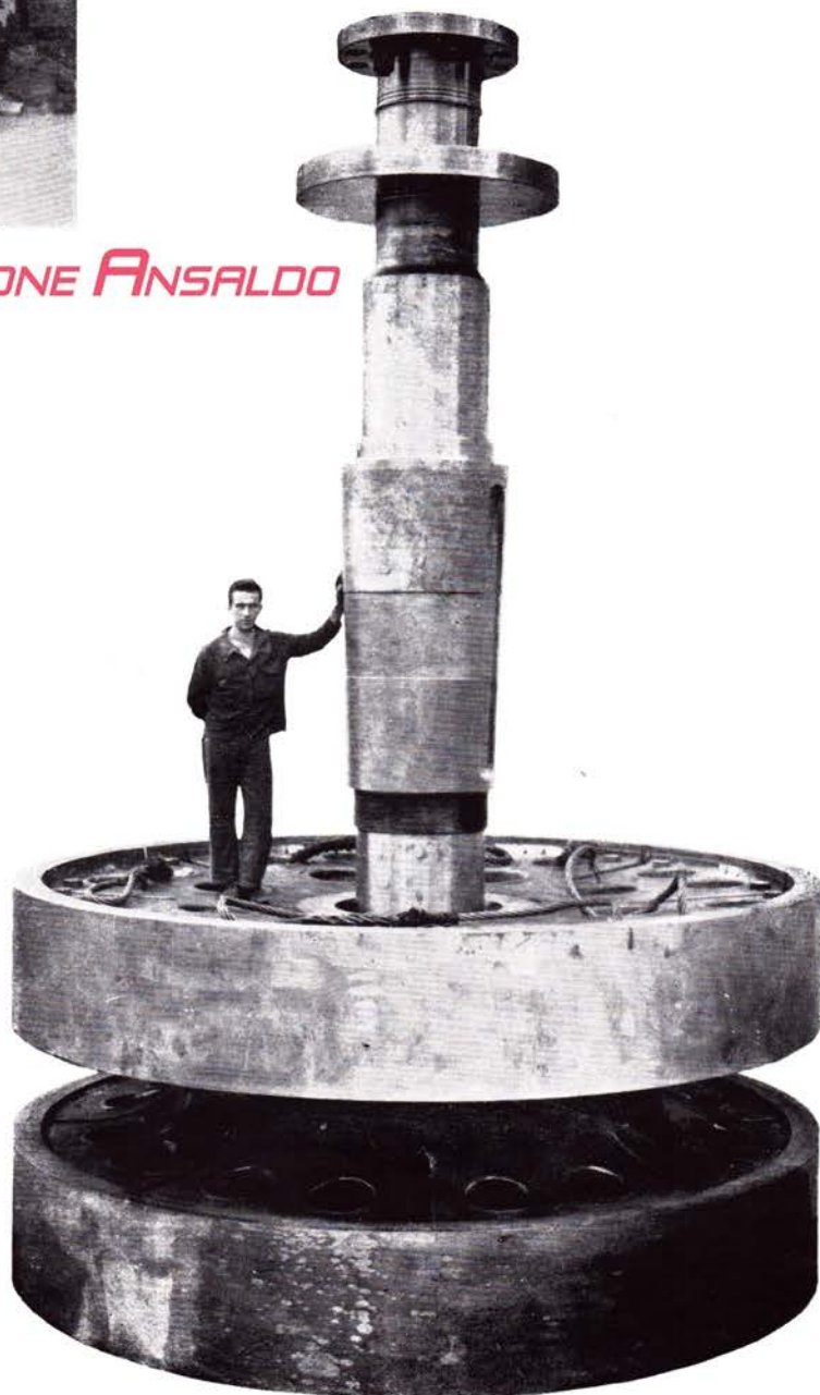
Aggiustaggio dell'asse della ruota lenta
