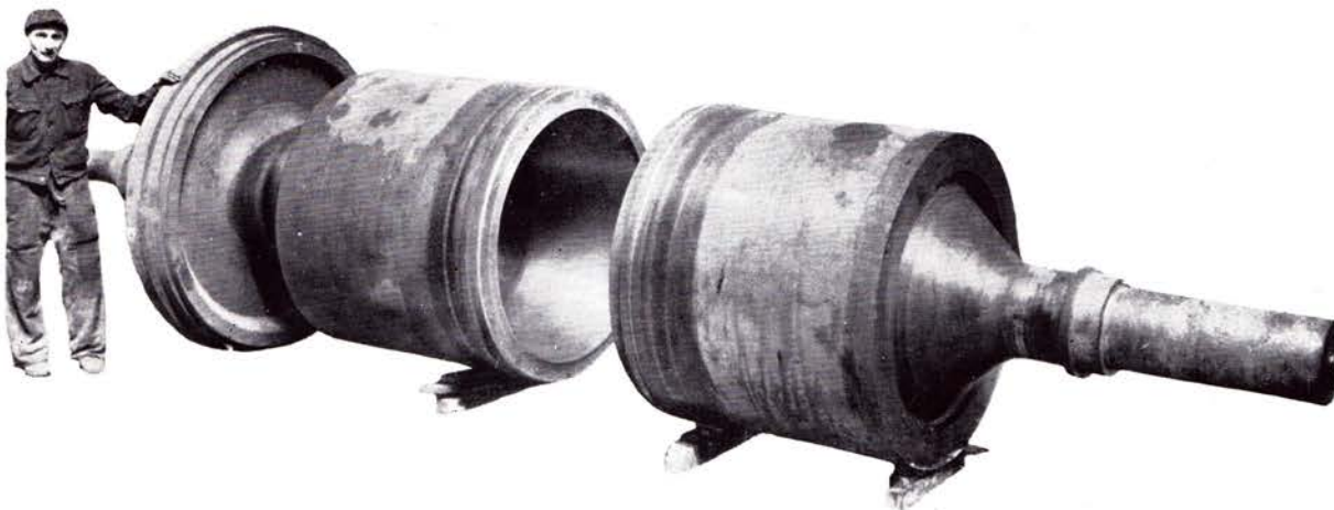
I due tronchi cavi di cui è composto il rotore di BP prima della saldatura
