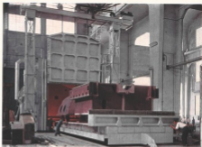
SMONTATURA della cassa di una turbina a vapore nello stabilimento Ansaldo di Genova-Sampierdarena. Si vede nella fotografia il più grande e moderno banco per ricotture che ci sia in Italia. Sotto: la turbina per Chivasso in un disegno immaginario di Rocco Borella.
