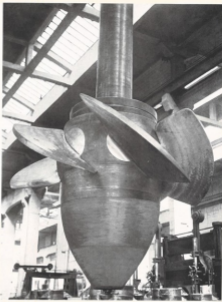
PANTOFOLARE della girante di una turbina Kaplan. Le giranti delle due turbine di Stagno, a quattro pale, hanno un diametro di m 7,294 e pesano 55 tonnellate ciascuna. L'albero internamente in acciaio ha un diametro di m 0,84 ed è lungo 7 metri e mezzo.
