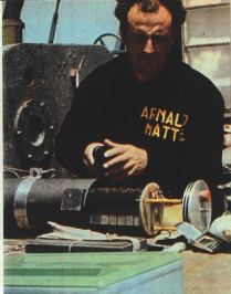
Arnaldo Mattei colloca all'interno di un contenitore stagno una serie di piccole e potenti batterie che forniranno la luce necessaria a squarciare le tenebre che avvolgono l'«Andrea Doria».
