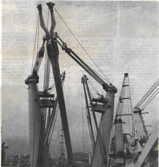
L'imponente bigo da 300 tonnellate della M/n CORTINA.
