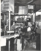
MACCHINA di chiusura e vuotoatura dei tubi elettronici tipo G. T.
