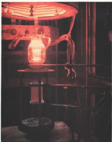
VIGILATURA di un tubo elettronico incandescente di grande potenza nello stabilimento dell'Agilla della Marconi Italiana.
