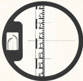
CAMPO del cannocchiale del tachometro autorileggitore Salomaggi mod. 4158. Caratteristica essenziale di questo tachometro è la serie di tratti radiali incisi sul cerchio sensibile che fornisce i riferimenti per far passare al cannocchiale una precisione esatta e, in pari tempo, serie di tratti successivi utilizzabili per leggere sulla scala la distanza ridotta all'orizzonte. Sotto: nell'alto a contatto elettrico della Salomaggi, Tavola di Base.
