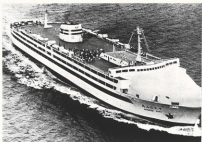
Oyama-Hokkaido, Giappone — Nave traghetto più grande del mondo. La « Bismarck Maru » che fa stesso servizio tra Oyar e Hokkaido, sul settentrione delle isole giapponesi, porta 9.000 ton. La sua velocità di crociera è di ventidue nodi. Sul traghetto-crociera trovano posto 500 passeggeri e 250 automobili.
