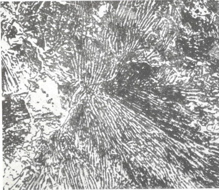
I PEZZI METALLICI soggetti a sforzi alternati subiscono una modificazione profonda della struttura. La perlite lamellare (a
