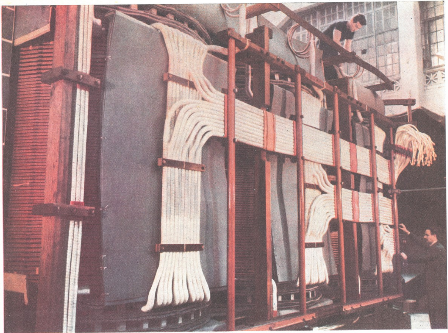
RAMIFICAZIONI di cavi lungo la schiena di un trasformatore da 50.000 KVA costruito dall'Ansaldo-San Giorgio per la Centrale di Bussolengo. I cavi ricevono un bagno di olio isolante.
