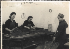
sopra: Fonderia: formatura a mano. sotto: Sta/Mucci - un aspetto dell'ufficio produzione.
